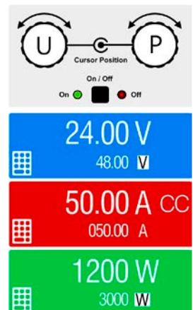
Je nach getroffener Wahl wird dem rechten Drehknopf ein anderer Sollwert zum Einstellen zugeordnet, während der linke Drehknopf immer die Spannung stellt.
