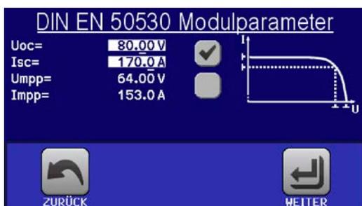
Schritt 2: Grundparameter des Solarmoduls eingeben
