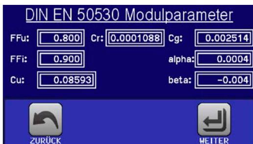
Schritt 1-1: Technologieparameter setzen
